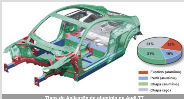
Tipos de Aplicação do alumínio no Audi TT
