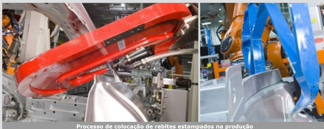
Processo de colocação de rebites estampados na produção
