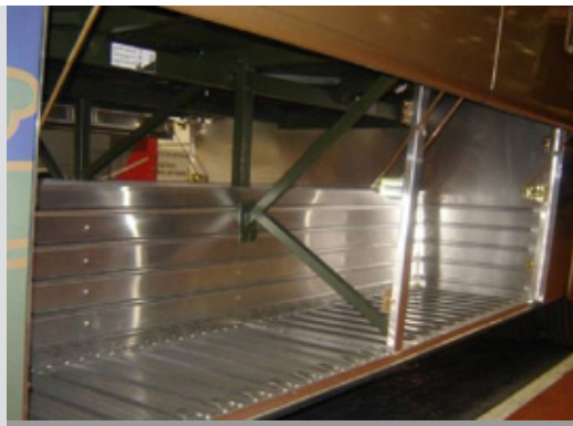
Marcopolo utiliza alumínio em revestimento, janelas, portas, porta-pacotes, piso e escadas, suportes e acabamentos.
