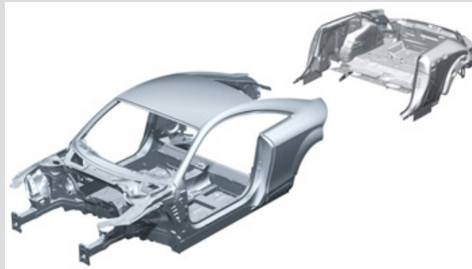
Carroceria híbrida do Audi TT tem 69% em alumínio.
